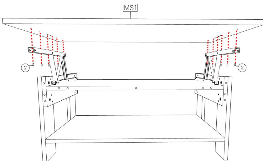
Se recomienda montar la pieza MS1 con el mueble apoyado en el lado derecho y posteriormente en el izquierdo.
